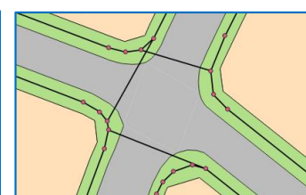
幅員5.5m以上の道路で横断歩道が抽出されない
