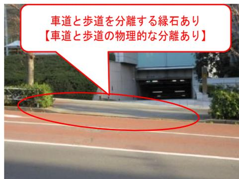
図3. 6 横断歩道の路面標示の無い道路の横断部の例
