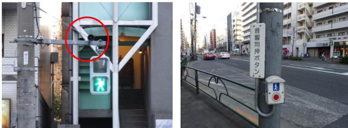
図3. 11 音響式歩行者用信号機の例（左：音響スピーカー 右：音響用押しボタン）
