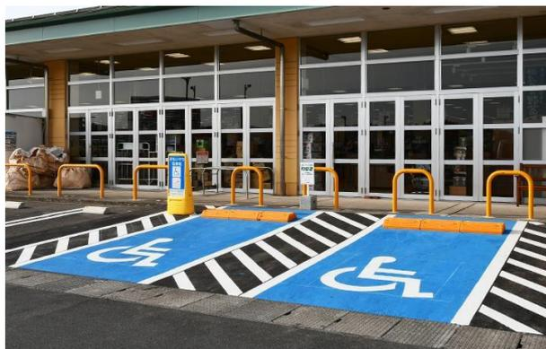
図3. 3. 35 車椅子使用者用駐車施設の設置例
