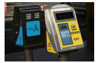
簡易改札機の例 (高松琴平電気鉄道株式会社)
