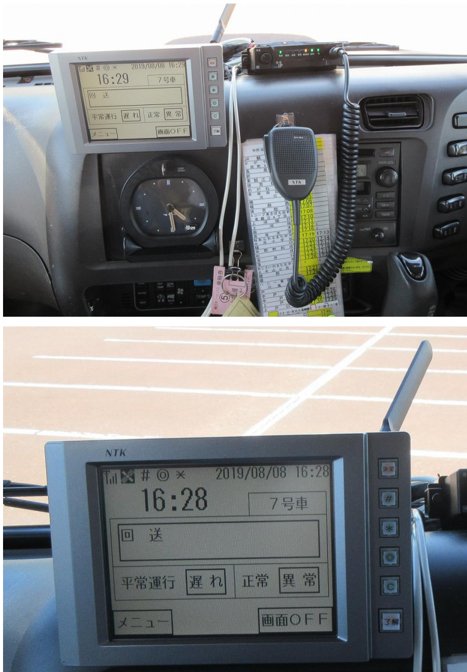
図 8 バスロケーション情報発信端末 (上：端末および無線機 下：端末操作画面)
