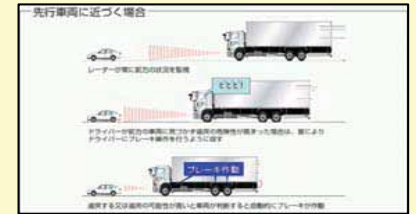
衝突被害軽減ブレーキの概要
