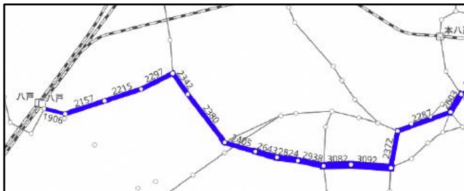
データ分析システムで集計した車内人員を路線に表示したもの
