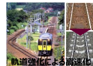
軌道強化による高速化
