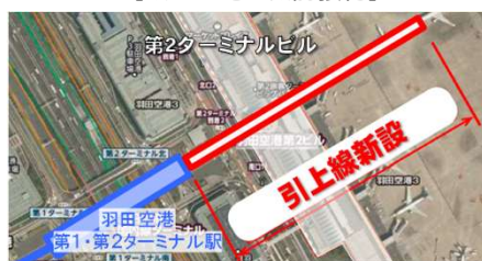
【羽田空港駅における引上線の新設】
