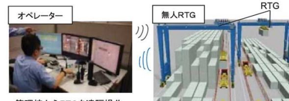
管理棟からRTGを遠隔操作
