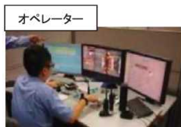
管理棟からRTGを遠隔操作
