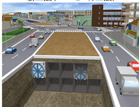
新工法(ハーモニカ工法)
