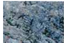
写真-2: チャート近景 ダムサイトは主にチャートと呼ばれる非常に硬い岩で形成されている
