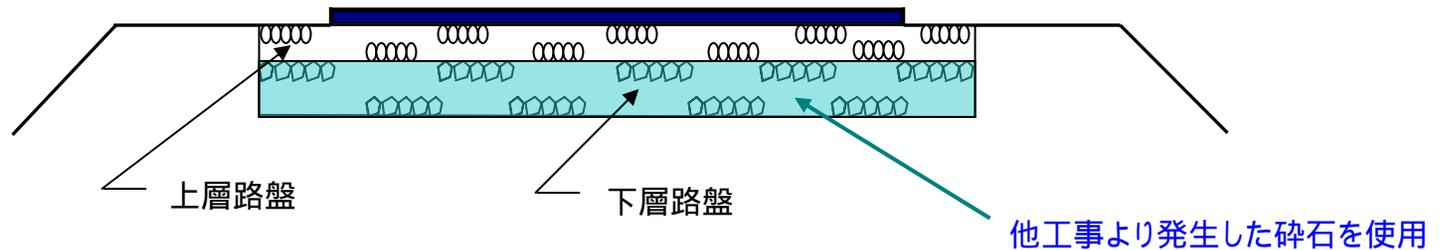
そのほかにも、側溝、集水桝、フェンス基礎の砕石にも、他工事より発生した砕石を使用
