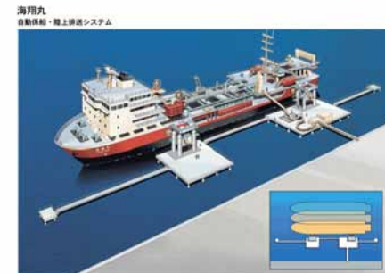
自動係船装置による離接岸作業
