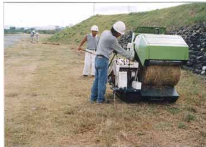
除草材の梱包状況
