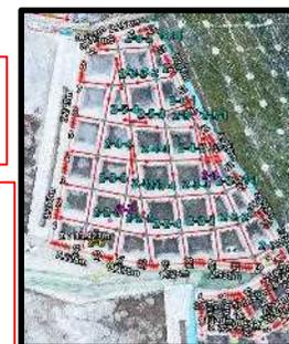
⑤⑥3D-CADや点群処理ソフトを用いて点群から法枠の寸法や面積を自動算出
