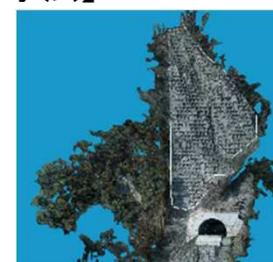
④TLSやUAVで法枠の点群を計測
