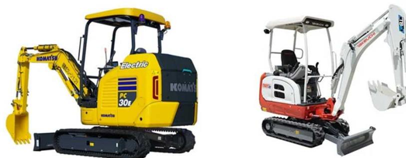
バッテリー式電動小型油圧ショベルの例(出典: (左)コマツHP、(右)竹内製作所HP)
