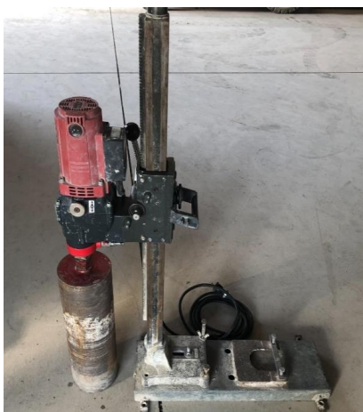
コンクリート穿孔機全景
