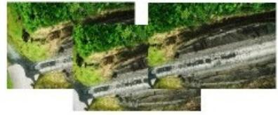
**球面補正** 写真測量時の撮影画像の歪み等を補正する処理を実施
