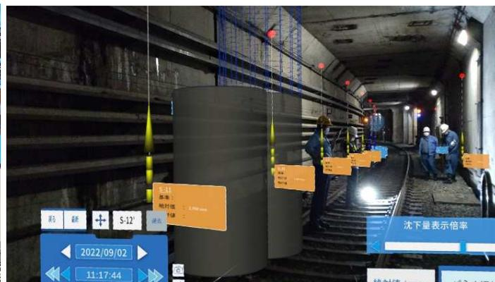
地盤改良の施工位置や進捗・各種計測センサ情報をリアルタイムに可視化するだけでなく、空中に書き込みが可能(奥村組)
