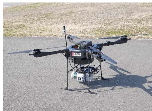
レーザ測量機搭載状況
