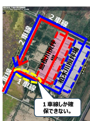
攪拌場の運搬経路は2現場で共有
