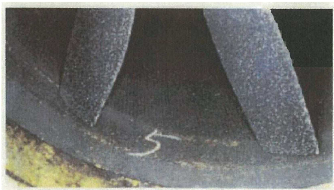
写真－６ 羽根車：ダスト付着〔有〕
