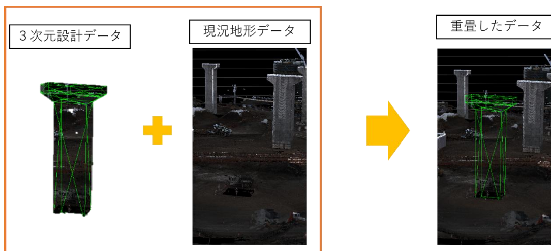
図 2-8 3次元データの重畳イメージ [構造物工（橋脚・橋台）]
