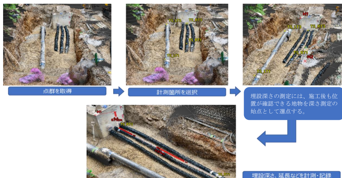
図16-2 出来形計測箇所の抽出と埋設深さ・延長の計測方法
