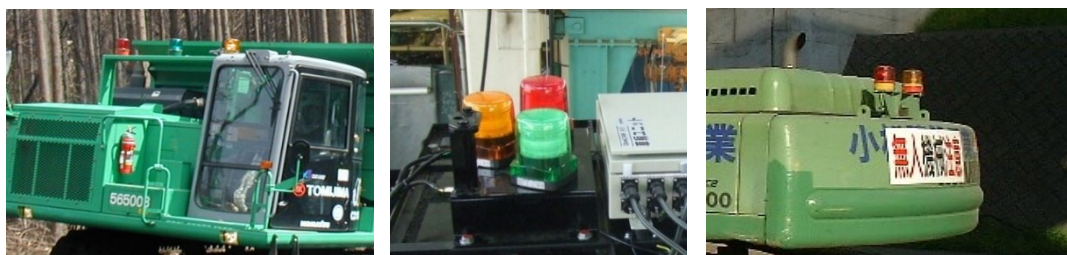
写真 5.1 自動建設機械の表示灯の例
