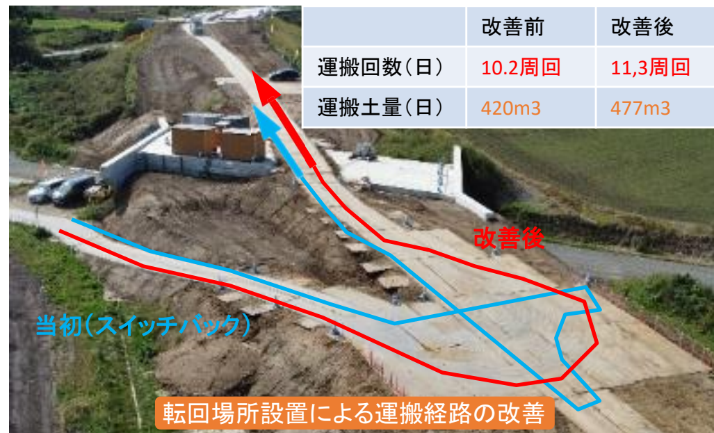
転回場所設置による運搬経路の改善 当初の運搬経路と改善後の運搬経路の比較 期間[日]
