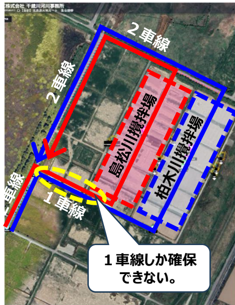
攪拌場の運搬経路は2現場で共有
