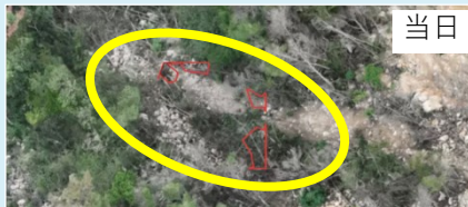
赤枠：自動検出された地形変化 AIによる地形変化の検出結果
