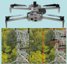
障害物検知の様子(赤枠) (出典) Skydio HPより
