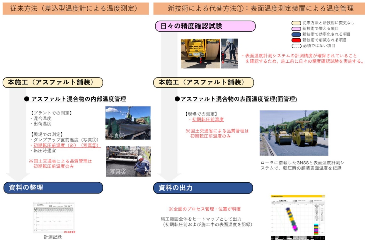
図 1.1 従来の管理方法と本管理要領(案)による管理方法の作業範囲
