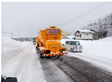
凍結防止剤散布状況
