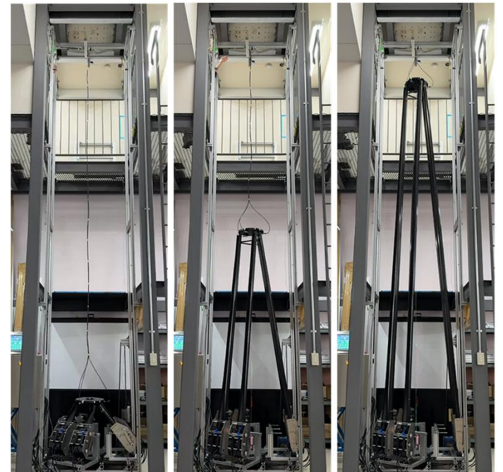
5mタワー支柱展開BBM試験
