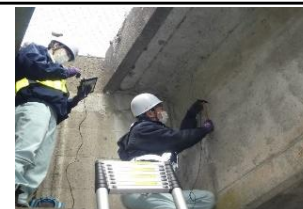
AEセンサを利用した PCグラウト充填把握
