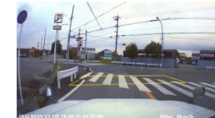
ドライブレコーダーで取得した画像による区画線の摩耗判定
