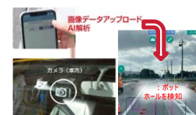
スマートフォンで取得した画像によるポットホール検知
