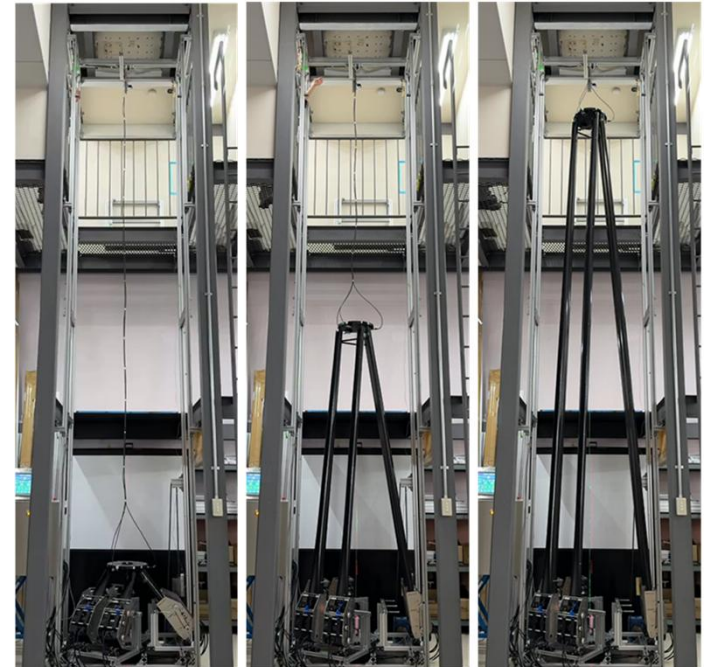
5mタワー支柱展開BBM試験
