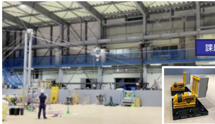
簡易支柱およびウインチを用いた屋内実証試験
