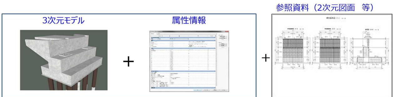
図 5 BIM/CIM モデルの構成
