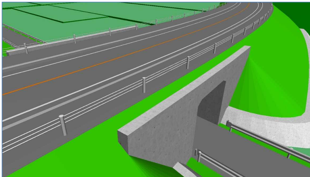
図 8 道路土工の CIM モデル
