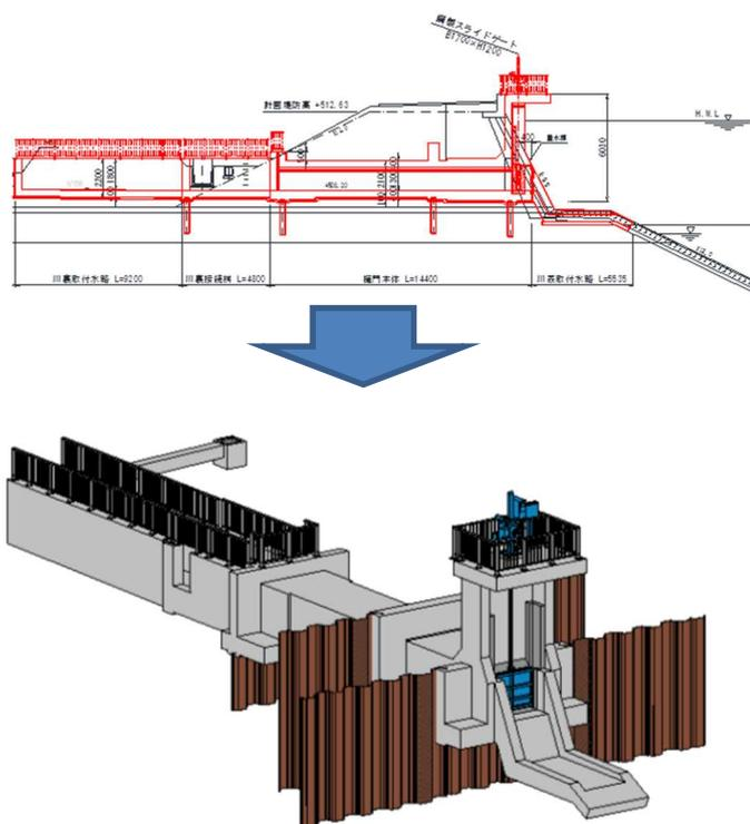
図 13 樋門・樋管モデルの例
