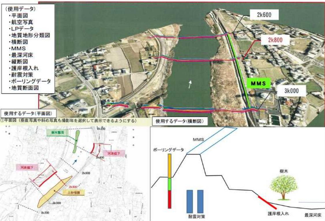
図 26 基本フレームのイメージと河川CIMの整備イメージ(最終形)
