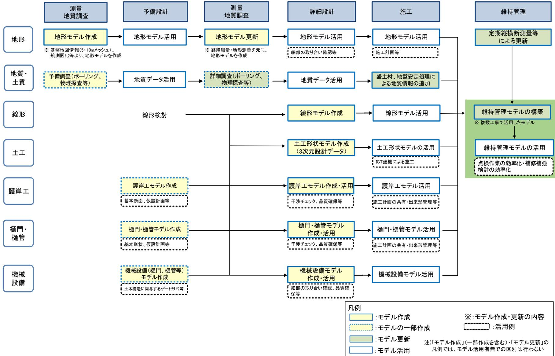
図 4 河川堤防及び構造物における CIM モデルの作成、更新及び活用の流れの例
