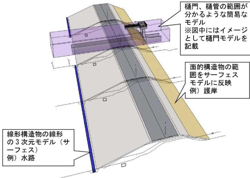
図 10 骨格構造モデル（スケルトンモデル）とサーフェスモデルの例（付帯工）
