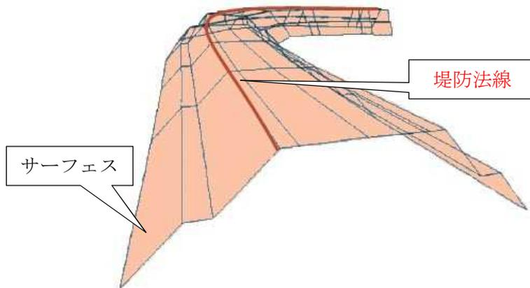
図 9 骨格構造モデル（スケルトンモデル）とサーフェスモデルの例（堤防）
