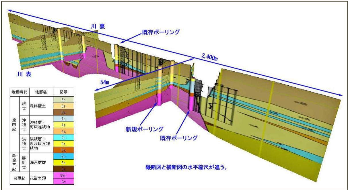
図 5 河川堤防（堤防地質縦断面図、横断面図、ボーリング（推定・解釈））の準 3 次元地盤モデルの表示例
