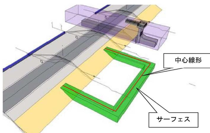
図 11 骨格構造モデル（スケルトンモデル）とサーフェスモデルの例（仮設工）
