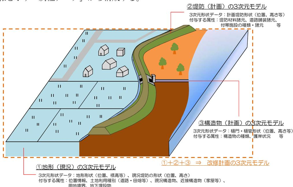
図 6 堤防及び構造物モデルの構成例
