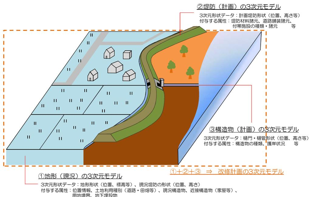
図 12 堤防及び構造物モデルの構成例
