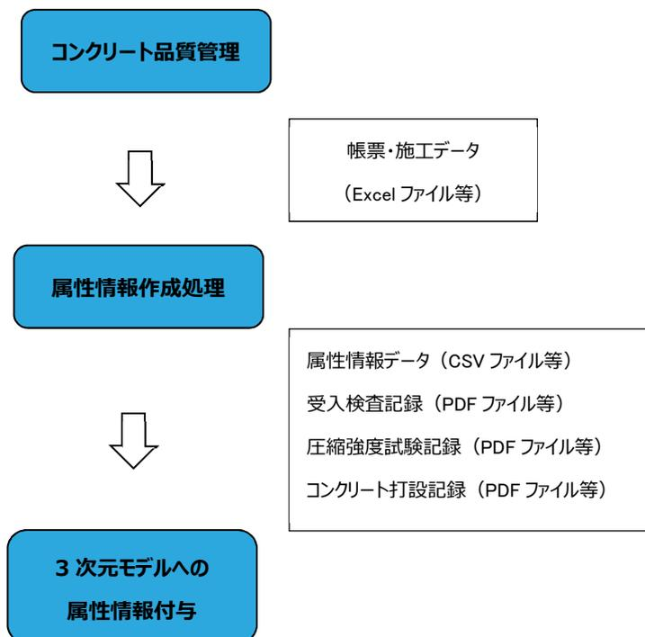
図 17 施工中の属性情報付与の流れ（例）
