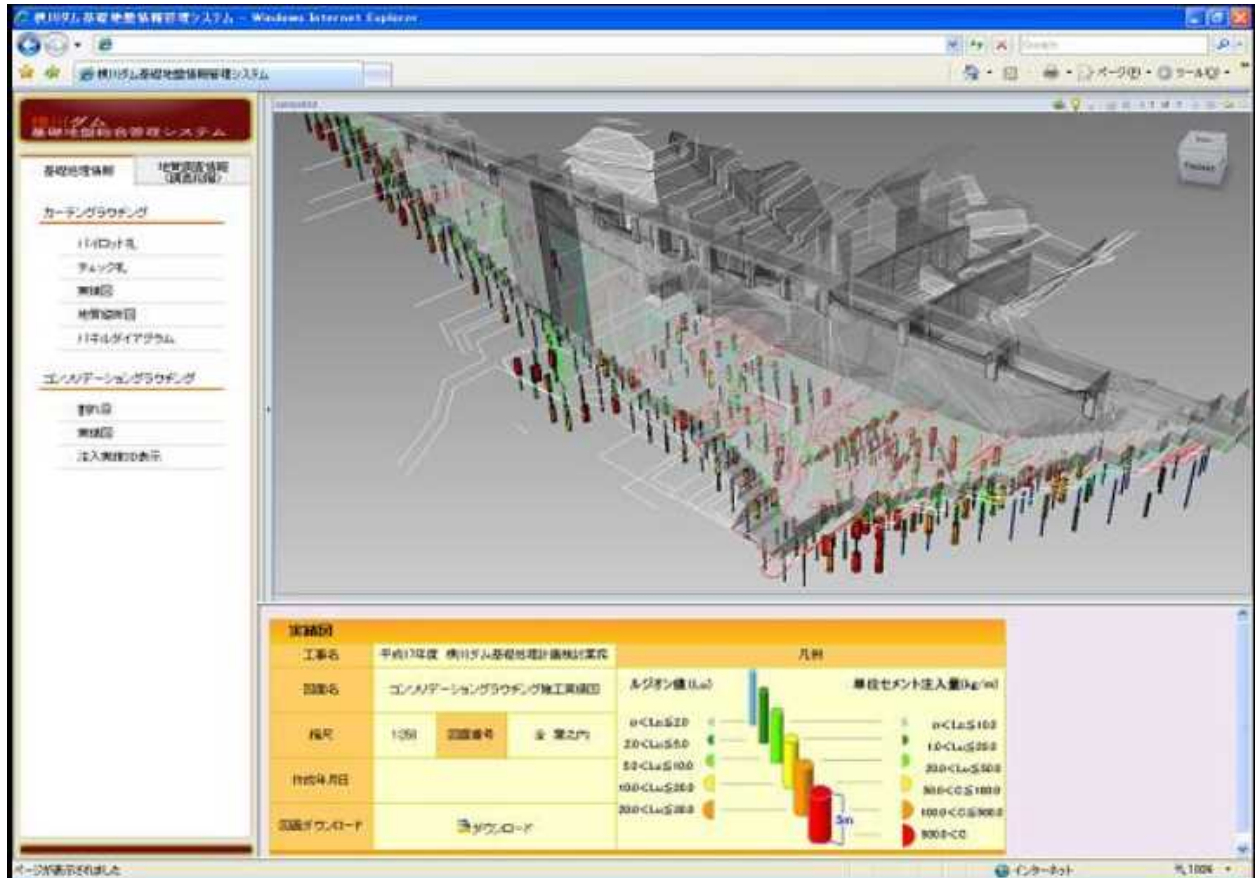
図 26 ダム基礎地盤コンソリデーショングラウチングの3次元可視化
