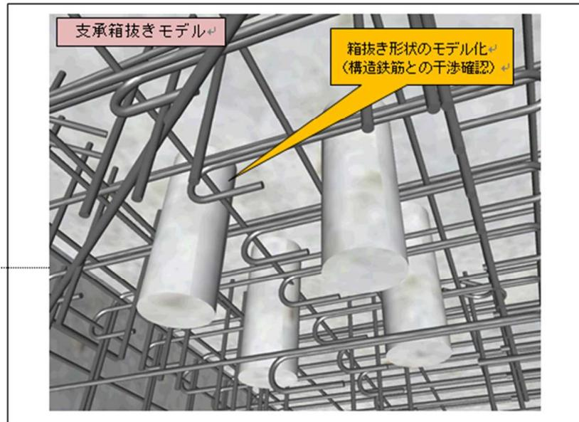
図 28 モデルイメージ（支承箱抜き：下部工）
