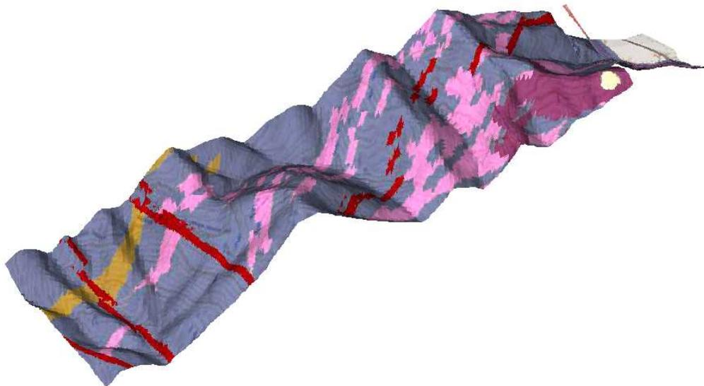
テクスチャモデル（準3次元地質平面図）（数値標高モデルとの合成モデル）
