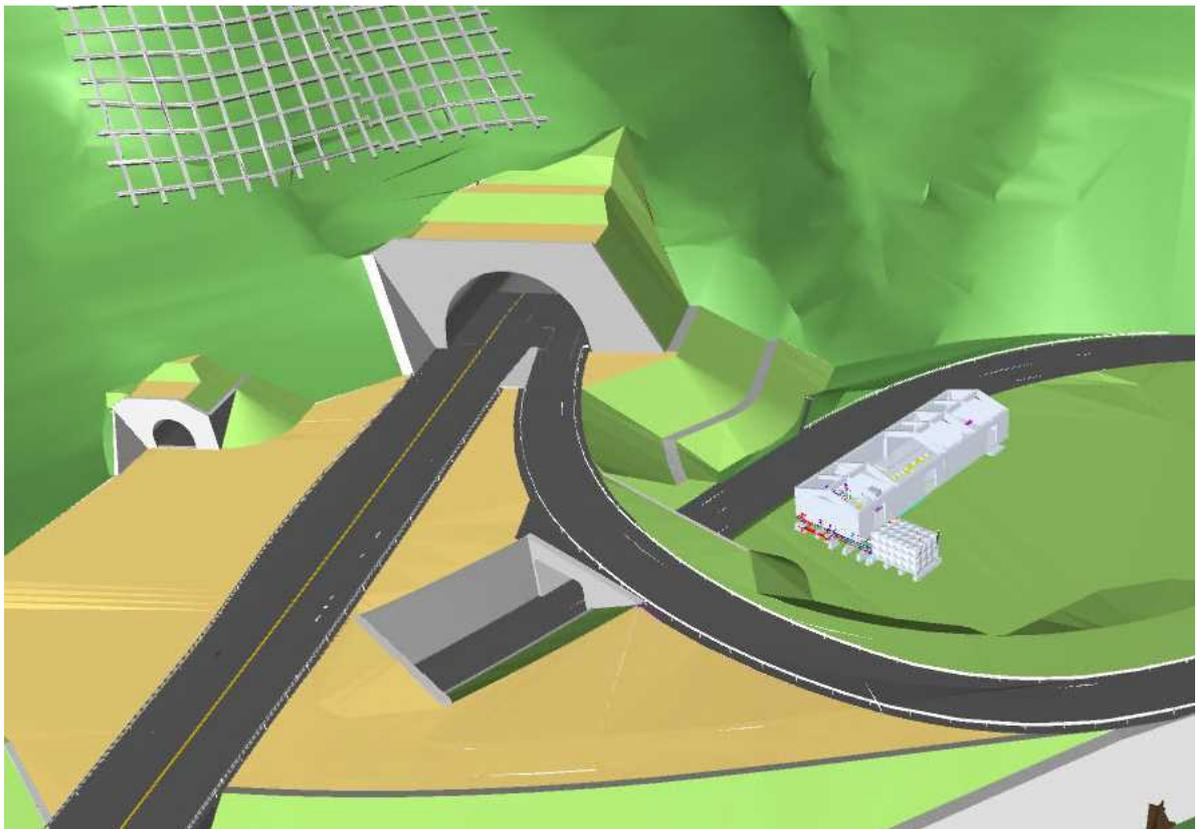
図 13 トンネル本体にポンプ室・電気室を重ねた統合モデル
