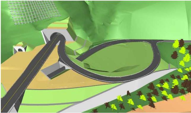
図 11 トンネル本体工事の統合モデル
