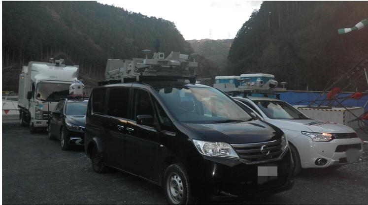
図 17 計測に使用した車載型レーザー 4 種
