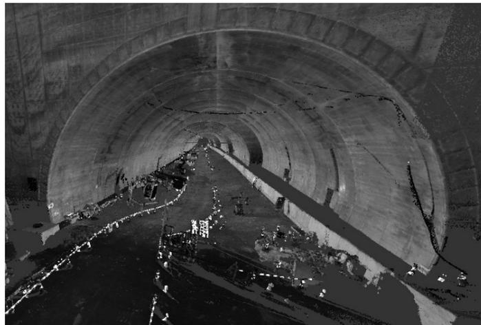
図 18 点群によるトンネル坑口部データ
