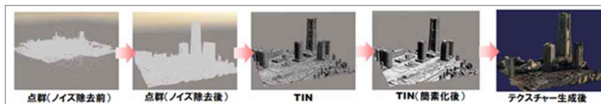
図 51 航空写真撮影による鳥瞰図作成プロセス
