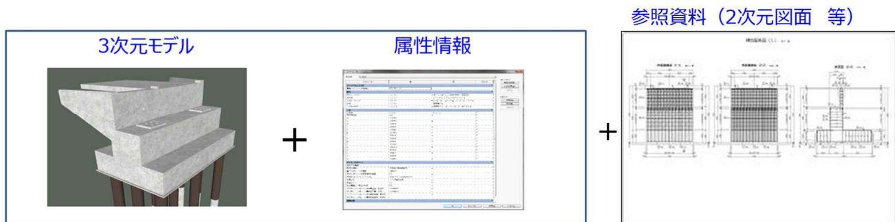
図 12 構造物モデルの例
