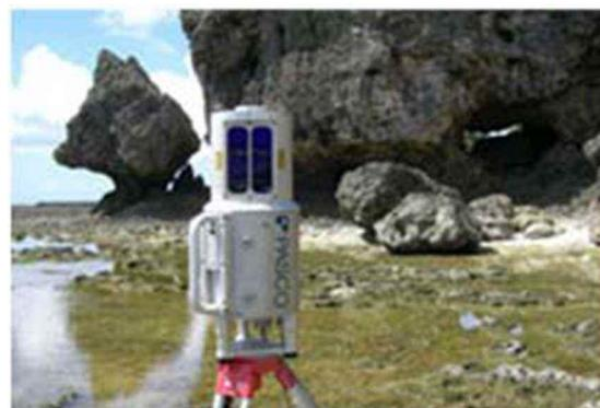
図 44 地上レーザ測量
