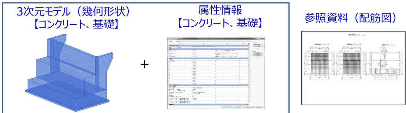
図 6 参照資料を使用する BIM/CIM モデルの事例
