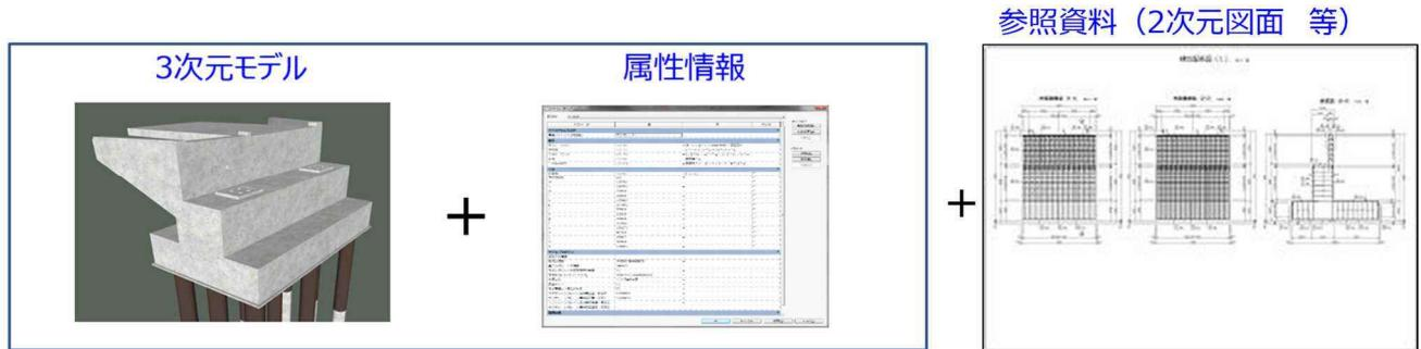
図 5 BIM/CIM モデルの構成
