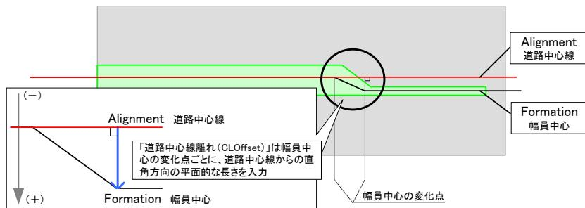
図 3-3 道路中心線形離れの考え方（平面）
