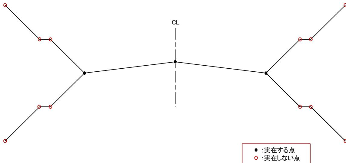
図 4-14 標準横断面の定義方法
