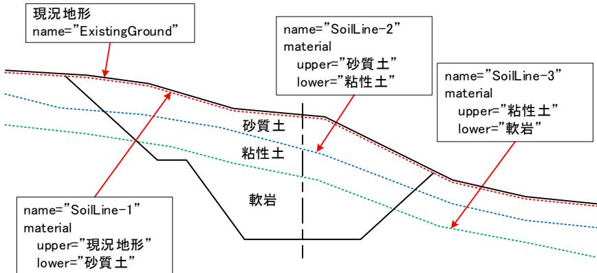
図 4-30 地形線を用いた地層表現例（1）
