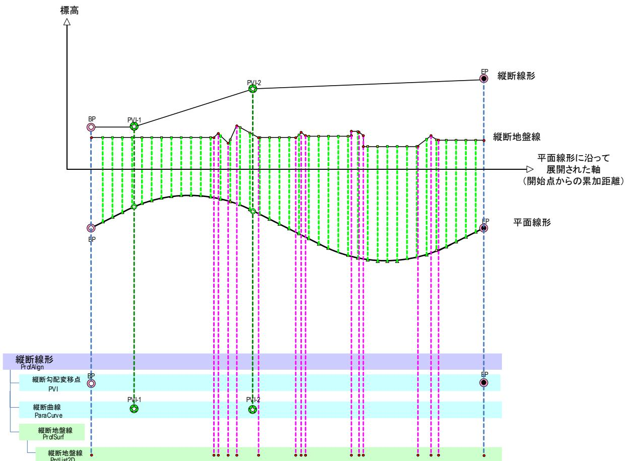
図 2-6 平面線形と縦断線形の対応
