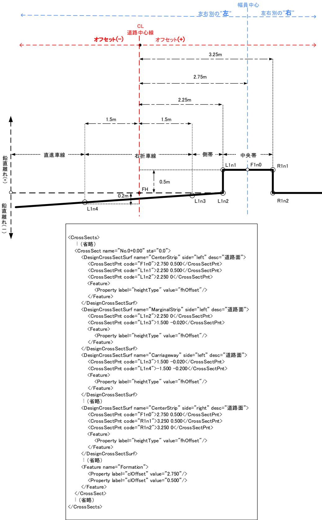
図 4-25 幅員中心と道路中心線が異なる場合の作成方法
