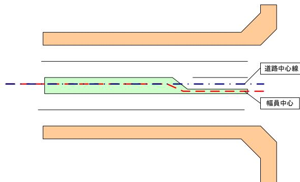
図 3-2 幅員中心の平面図上の位置づけ
