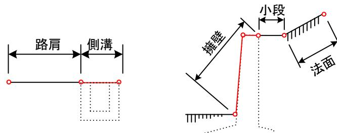
図 4-22 構造物『表面』の作成方法（左：側溝 右：擁壁）
