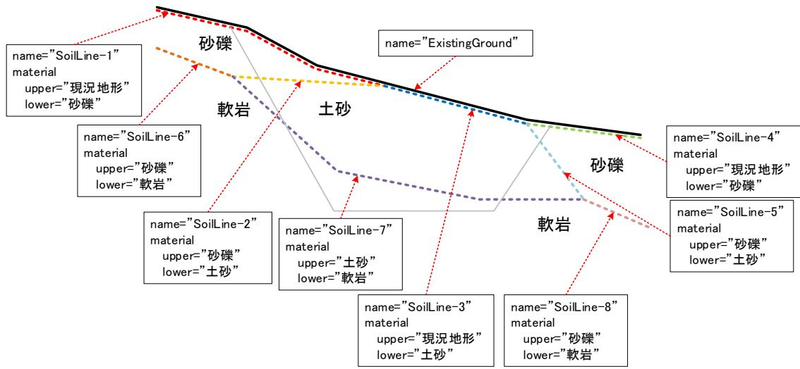
図 4-31 地形線を用いた地層線の例（2）
