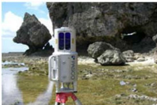
図 26 地上レーザ測量
