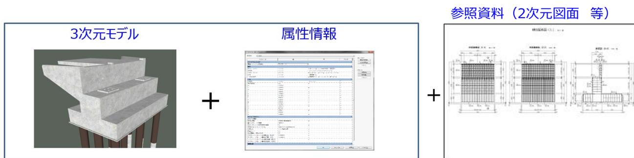
図 6 BIM/CIM モデルの構成
