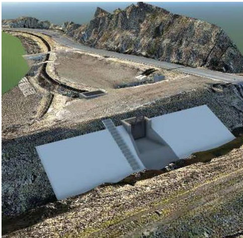
図 18 構造設計（一般図作成）において活用する BIM/CIM モデルの例
