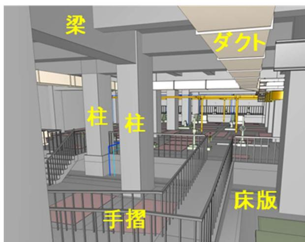
図 24 各部材によるモデル作成例
