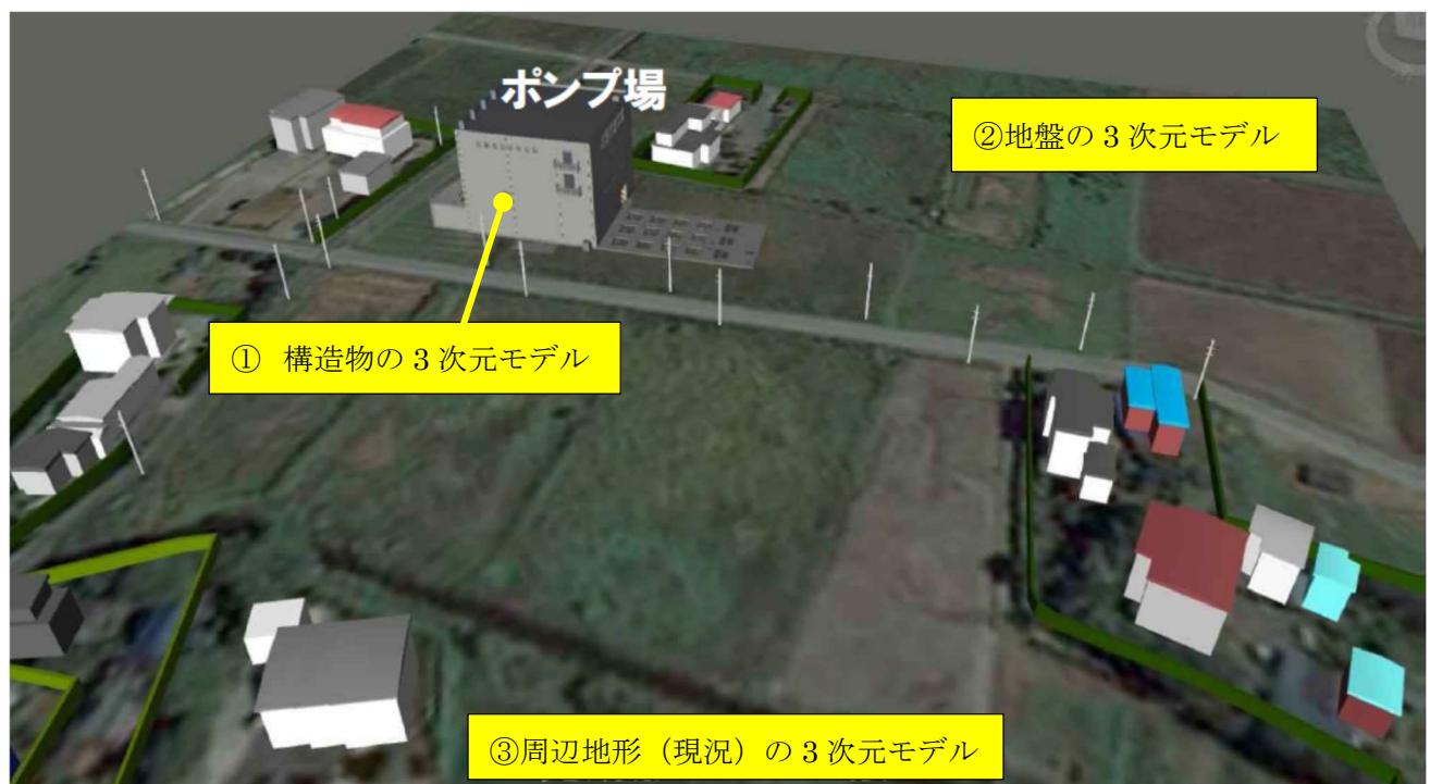
図 25 下水道ポンプ場施設における BIM/CIM モデルの構成例
