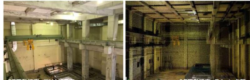
また、既存設備が錯綜する狭隘な空間では、運搬時に既存設備等との接触による損傷・挟まれ等の事故が生じる恐れがあるため、3次元モデルを用いて高精度で立体的に可視化することで安全管理の効率化、高度化が期待できる。
