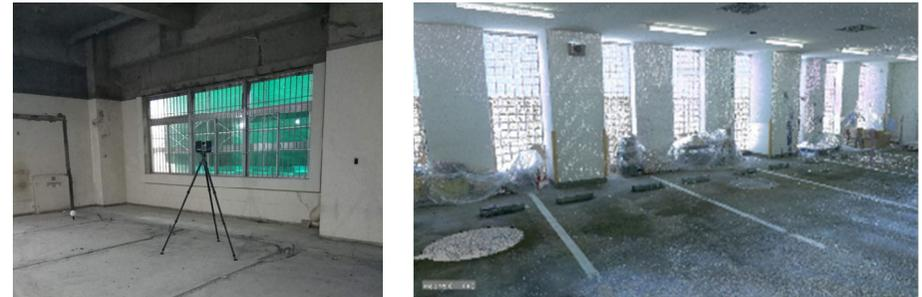
デジタル測量データのBIMデータへの統合
