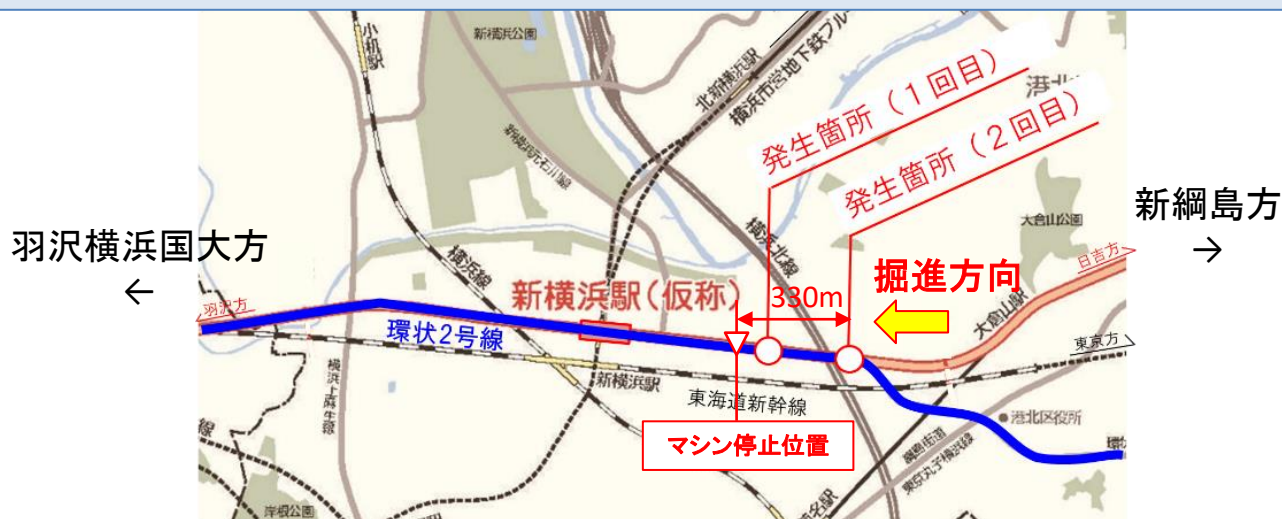
切羽の後方約30mで陥没発生
