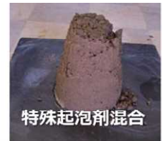
礫質土の起泡剤混合の例
