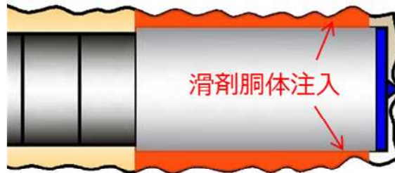
シールド機胴体注入の概念図
