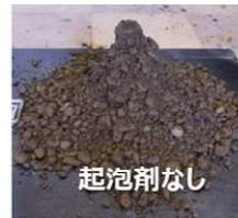
礫質土の起泡剤混合の例
